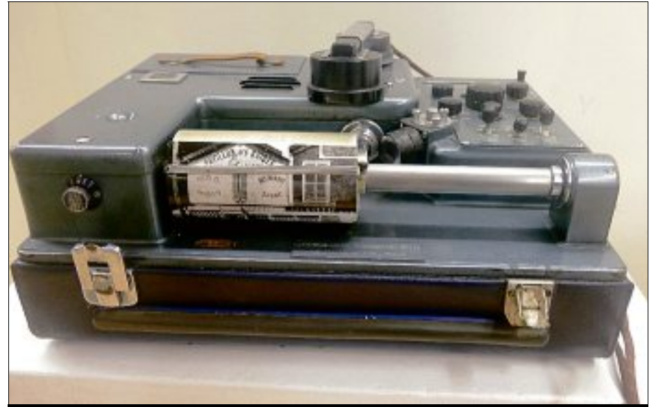
BÉLINOGRAPHE. Ancêtre du télécopieur, cet appareil a alimenté les journaux en photos, jusque dans les années 80.
